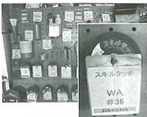
写真3 以前は、グラインダーのと石など、消耗品の発注遅れや過剰発注などが頻発した。現在は、消耗品ごとに、最大在庫数、最少数、発注単位が明記され、最少数になった時点で誰でも発注できるようにしている。消耗品費用は以前の4分の1程度になったという。
